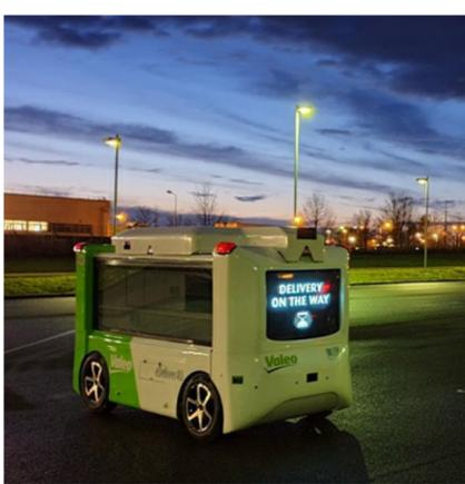
Ce robot dernière génération peut circuler jusqu'à 12km/h de manière autonome en milieu urbain. Il pourrait à terme livrer des repas à domicile commandés en ligne (jusqu'à 17 repas par trajet) grâce à un caisson de livraison connecté. Le client l'ouvrirait à l'aide d'une application mobile garantissant la sécurité des livraisons.
