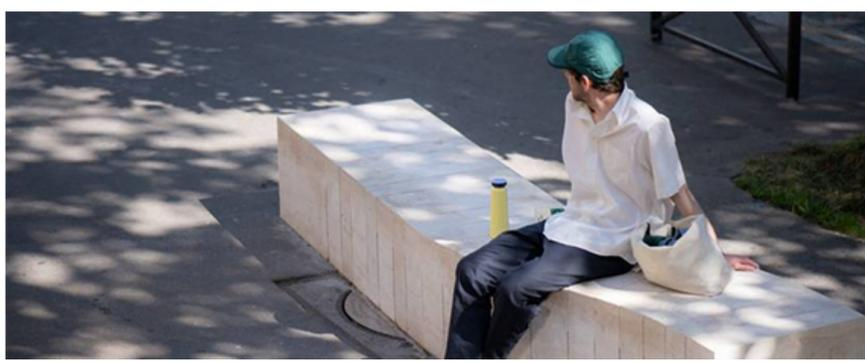
Ce "blanc climatique" a été testé durant la période estivale. Son fonctionnement repose sur un procédé ingénieux : **puiser l'air frais sous terre pour le réinsuffler**, générant ainsi un véritable coussin d'air frais ! La température avoisine alors 20°C... **ce système ne se déclenche que si la température extérieure dépasse les 25°C**. L'expérimentation dure jusqu'au 15 septembre puis laissera place au bilan.
